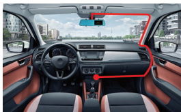
Пример монтажа с про-кладкой кабеля питания
